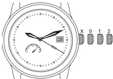
Модели BALL Power Reserve оснащены индикатором запаса хода, который показывает уровень завода часов. При уменьшении запаса хода часов индикатор будет поворачиваться против часовой стрелки. Во время завода часов вручную, а также когда Вы носите часы на руке, индикатор запаса хода будет поворачиваться по часовой стрелке.
