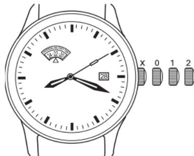
У моделей Trainmaster Cleveland Express Dual Time (GM1020) и Fireman Night Train (NM1092) есть 24-часовой индикатор на отметке 11 часов. Его показания привязаны ко времени основного часового пояса – следовательно, они отображают Всемирное координированное время UTC или Универсальное военное время UMT в 24-часовом формате.
