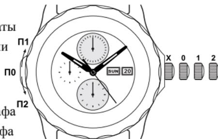
Запатентованная система Slide Хронограф включает в себя закругленный шток, огибающий корпус, который делает возможным управление всеми функциями хронографа – запуск, остановка и сброс показаний – ползунковым регулятором у отметки 9 часов. Управление функциями имеет интуитивный характер и осуществляется путем передвижения ползунка.
