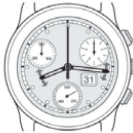
время с точностью до секунды, вытяните головку в момент, когда секундная стрелка указывает на 0. После установки часа и минуты, верните головку в положение I, сверяясь с сигналами точного времени.
