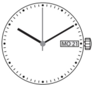
При выдвижении заводной головки в крайнее положение, стрелки часов останавливаются. Вращая заводную головку, вы можете изменить текущее время на ваших часах. Для настройки календаря, установите заводную головку в среднее положение и вращайте её вперед или назад, при этом будут меняться показания даты, либо дня недели.
