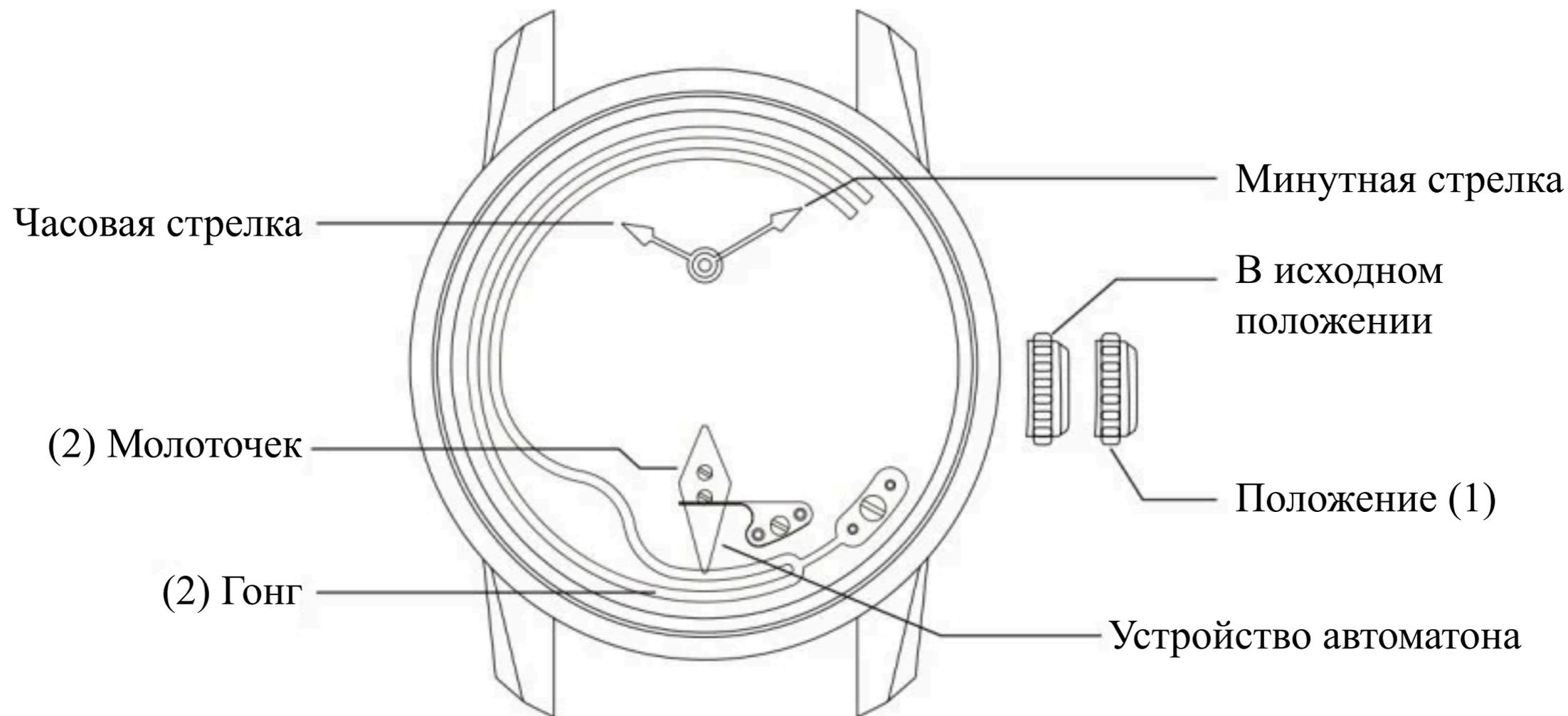
(1) Установка времени: Вытяните заводную головку в первое положение. Вращайте головку только против часовой стрелки для установки времени.
