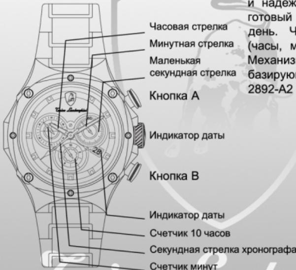
Ваши наручные часы - это точный и надежный хранитель времени, готовый служить Вам каждый день. Часы показывают время (часы, минуты, секунды) и дату. Механизм автоматический, базирующийся на механизме 2892-A2 (расширение DD 14405).
