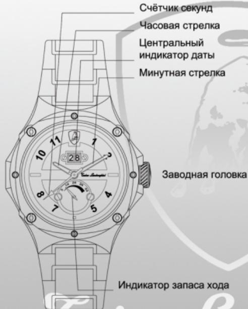
Ваши наручные часы - это точный и надежный хранитель времени, готовый служить Вам каждый день. Они оснащены автоматическим механизмом базирующимся на механизме 2892-A2 (расширение 9090).
