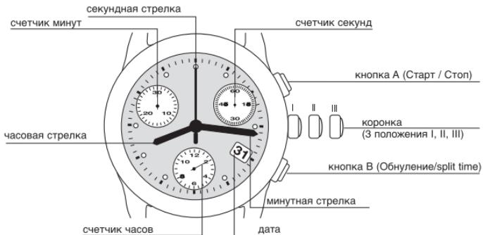
Внимание! Перед каждым хронометражем стрелки хронографа должны стоять в исходном положении (см. порядок обнуления счетчиков).
