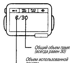
В режиме записной книжки (с выведенным на табло экраном телефонных номеров или экраном номеров факсов) вы можете определить объем использованной памяти нажатием кнопки [=] и удерживанием ее в нажатом состоянии.
