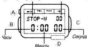
Режим секундомера позволяет измерять отдельные отрезки времени, разделенные времем, а также фиксировать время первого и второго места. Общий измеряемый интервал времени ограничен 23 часами 59 минутами 59,99 секундами. Измерение времени производится с точностью до одной сотой секунды.
