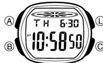
На рисунке изображен общий вид часов в Режиме Текущего Времени. Нажмите кнопку “B” для перехода из разряда в разряд в следующей последовательности:
