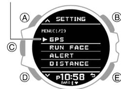
5. С помощью кнопок (A) и (D) переместите указатель, чтобы выделить [RUN FACE].
