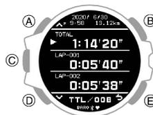
5. С помощью кнопок (A) и (D) выделите указателем элемент, сведения о котором необходимо просмотреть.
