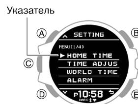
3. С помощью кнопок (A) и (D) переместите указатель, чтобы выделить [TIME ADJUSTMENT].
