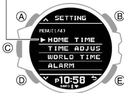
3. С помощью кнопок (A) и (D) переместите указатель, чтобы выделить [ALARM].
