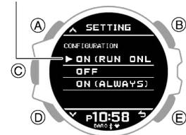
3. С помощью кнопок (A) и (D) выберите настройку «Вкл.»/«Выкл.».
