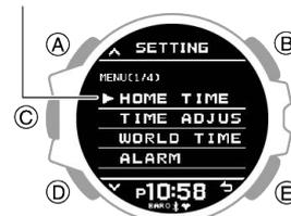
4. С помощью кнопок (A) и (D) переместите указатель, чтобы выделить [TIME ADJUSTMENT].
