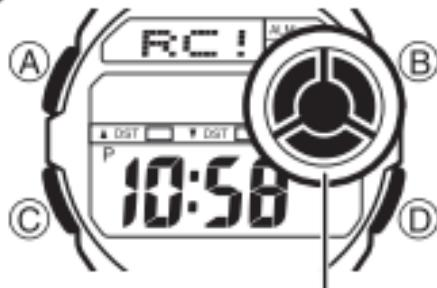
Индикатор мощности приема сигнала радиокалибровки
