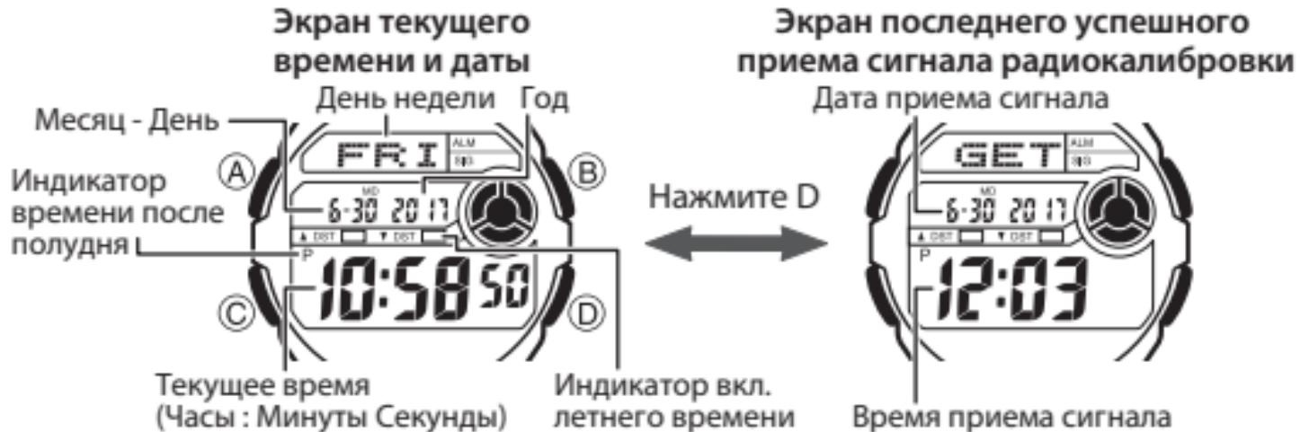
успешного приема сигнала радиокалибровки времени и даты (на экране отобразится индикатор GET). Нажмите кнопку D для возврата к предыдущему экрану.
