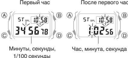
3. Нажмите (A), чтобы сбросить временные измерения на все нули.
