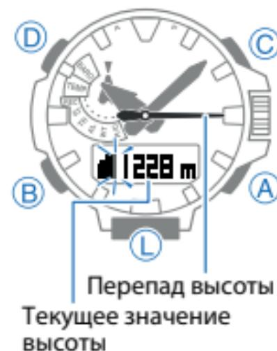
Значения перепада высот отображаются на экране часов с помощью секундной стрелки, как показано на рисунке.
