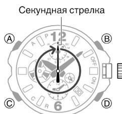
3. Для настройки положения секундной стрелки относительно 12 часов покрутите заводную головку.
