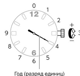
10. После сигнала точного времени по истечении минуты верните заводную головку в положение блокировки.
