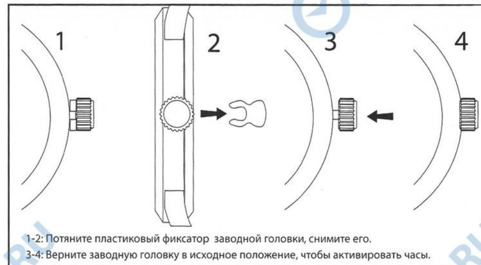
1-2: Потяните пластиковый фиксатор заводной головки, снимите его.
