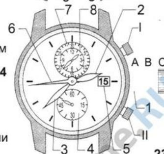
секундомера в исходном положении. Если секундомер включен, остановите его, нажав верхнюю кнопку «I», затем верните стрелки секундомера на ноль, нажав нижнюю кнопку «II».
