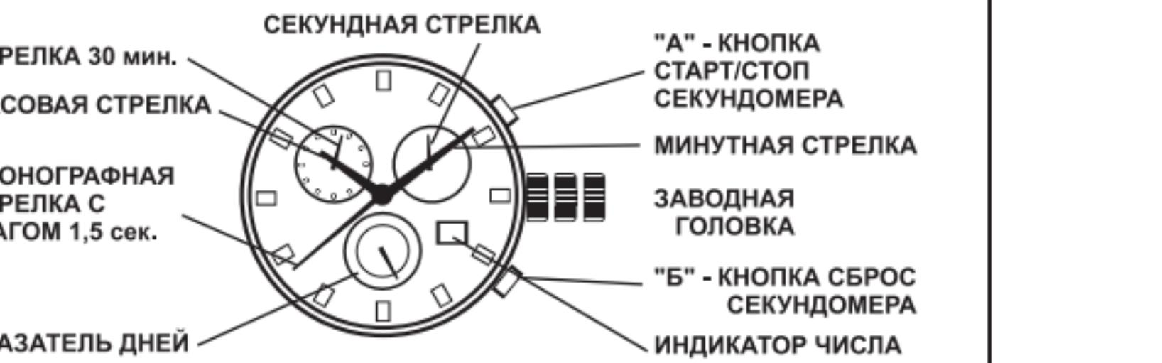
1. Для установки текущего времени необходимо оттянуть заводную головку до крайнего фиксированного положения и вращением головки по часовой стрелке установить стрелки на нужное время.
