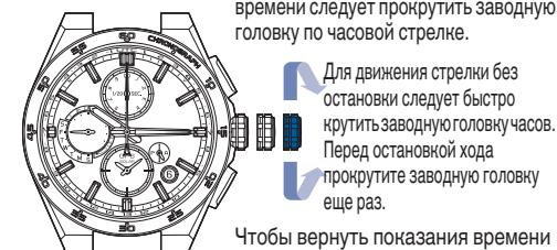
Чтобы вернуть показания времени назад, прокручивайте заводную головку против часовой стрелки.
