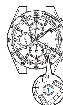
Для прокрутки стрелки на 1 шаг вперед поверните заводную головку по часовой стрелке.
