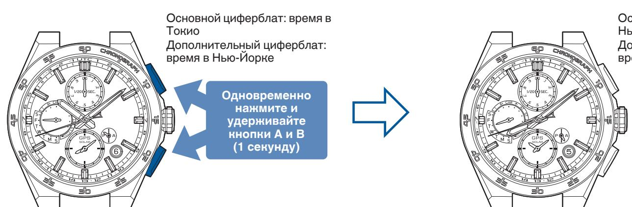
Секундная стрелка указывает на часовой пояс для включенного основного циферблата. Стрелка многофункционального индикатора показывает настройку параметра DST (летнее время) включенного основного циферблата.
