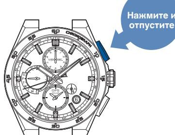
\* При нажатии и удерживании кнопки A часы переходят в режим ручной настройки времени.
