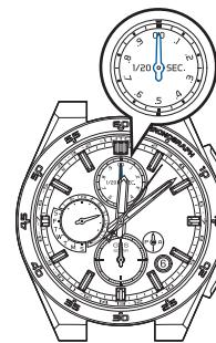
Для прокрутки стрелки на 1 шаг вперед поверните заводную головку по часовой стрелке.
