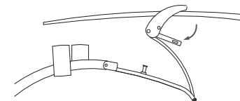
**3** Извлеките штифт из регулировочного отверстия ремешка. Сдвиньте браслет, чтобы отрегулировать его длину и найдите соответствующее отверстие. Вставьте в отверстие штифт.
