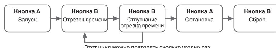
\* Если секундомер находится в состоянии измерения промежуточного времени, то, когда измеренное время достигает 12 часов, измерение прерывается автоматически.
