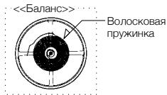
Иными словами, при высокой температуре волосковая пружинка расширяется, и часы начинают отставать, при низкой температуре пружинка сжимается, и часы идут вперед. Так обычно бывает.
