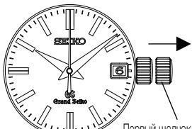
Часы показывают "31" вместо "1". Вытяните заводную головку до первого щелчка. Поверните заводную головку по часовой стрелке, чтобы настроить дату на "1" а затем верните головку в исходное положение.
