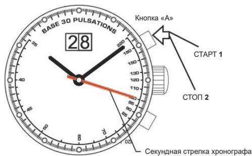
Шкалу **PULSOMETER** с помощью хронографа можно использовать для измерения пульса. Шкала тахометрического типа откалибрована на 15 или 30 ударов сердца. После запуска хронографа остановите его на 15-м или 30-м ударе сердца, и секундная стрелка покажет значение пульса в минуту.
