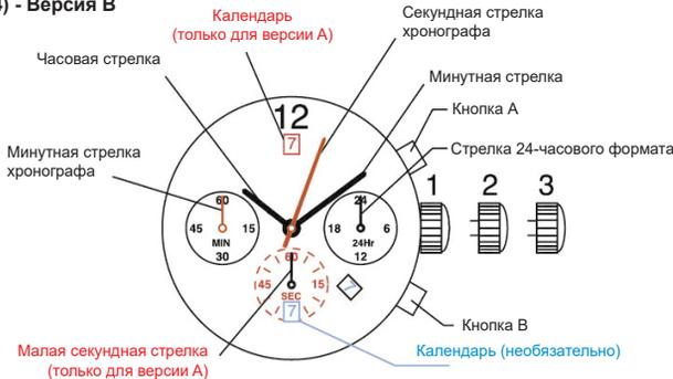
Данные часы оснащены простой функцией хронографа для измерения времени максимум до 59 минут 59 секунд с точностью до секунды.
