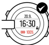
Чтобы полностью зарядить разряженную батарею, требуется 2–3 часа. Когда часы подключены к компьютеру с помощью USB-кабеля, все кнопки часов блокируются.
