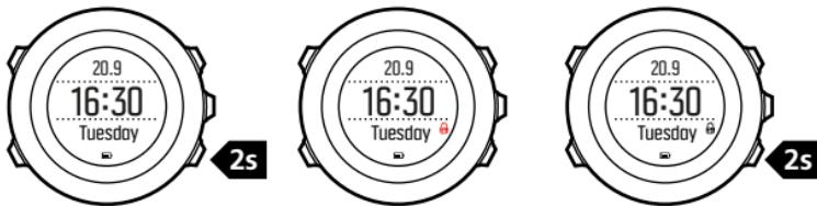
Режим блокировки кнопок можно изменить в параметрах часов, выбрав раздел **GENERAL** (Общие) **Tones/display / Button lock** (Сигналы/дисплей) / (Блокировка кнопок)
