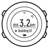
При движении со скоростью >4 км/ч часы показывают направление на интересующий пункт (или путевую точку, в случае навигации по маршруту), вычисленное с использованием данных GPS.
