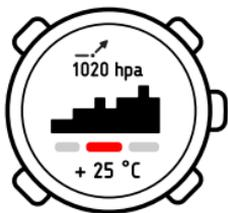
**ПРИМЕЧАНИЕ:** Если вы носите Suunto Core на запястье, для точного определения температуры окружающей среды следует снять устройство с руки, поскольку при контакте устройства с телом показания могут быть искажены.
