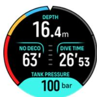
**ПРИМЕЧАНИЕ:** Если сопряжение с Suunto Tank POD не выполнено, в окне переключения вместо значения давления в баллоне будет отображаться надпись «ОТС. TANK POD». Если сопряжение с Suunto Tank POD выполнено, но данные не принимаются, в этом окне отображается - -. Причина этого может заключаться в том, что POD находится вне радиуса досягаемости, баллон закрыт или у батареи POD низкий заряд.
