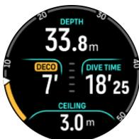
4. Значение потолка составляет 9 м, таким образом вы можете подняться на эту глубину, соблюдая ограничения скорости подъема. При приближении к глубине потолка и входе в зону декомпрессионного окна рядом со значением глубины появятся две стрелки, а в поле декомпрессии — таймер, отсчитывающий время декомпрессионной остановки (1 минута). Как только обратный отсчет таймера достигнет 0, снова появится значение TTS, а значение глубины потолка уменьшится на 3 м и станет равным 6 м.
