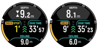
5. Изменение газовой смеси на 6 м. Время декомпрессии всегда рассчитывается с учетом допущения, что дайвер использует все газовые смеси, указанные в Списке газов. При подъеме на глубину 6 м предлагается переключиться на газовую смесь на NX99. После выполнения переключения появляется информация о текущей газовой смеси. Если вы решите отказаться от изменения газовой смеси, информация о декомпрессии станет неточной.
