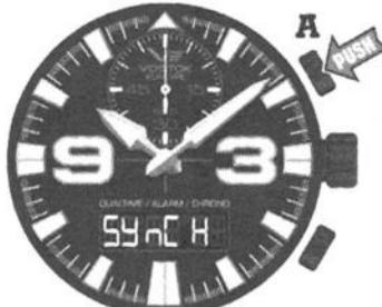
**Нажатие на кнопку А** перемещает секундную стрелку на малом циферблате.
