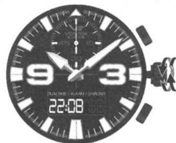
Для перемещения часовой и минутной стрелки **медленно и осторожно поворачивайте головку часов**. Показания на ЖК-индикаторе изменяются синхронно с вращением часовской стрелки.
