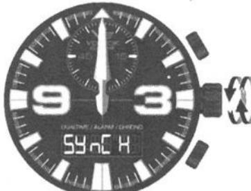
**Поворот головки** вращает минутную и часовую стрелки.
